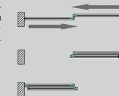
2. В системе из 3 или 4 полотен, полотна размещаются на двух направляющих, расположенных параллельно друг другу. Два крайних полотна располагаются позади и примыкают к стене, полотна являются стационарными и не движутся. Центральные полотна находятся в первом ряду конструкции, движение полотен происходит в направлении стационарных полотен от центра проема. Доводчик расположен только в активных полотнах.
